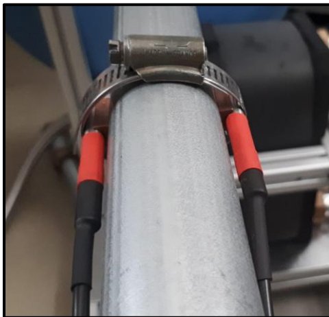
Image 4 : Installation des sondes sur les tuyaux avec isolation
