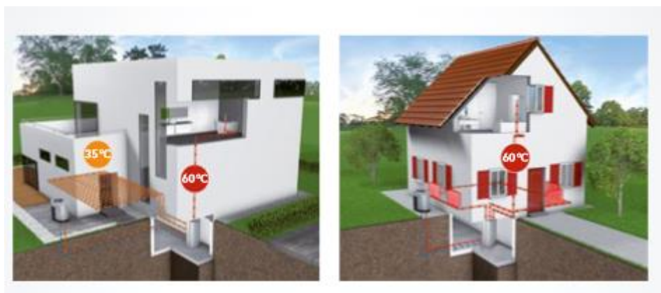
Figure 44 : Schéma tiré de la fiche technique de la pompe à chaleur (PAC_4).
